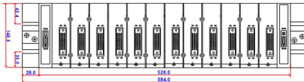
Рисунок 2.3 Монтажный размер панели с 12 слотами
