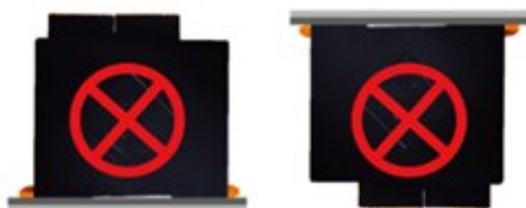
Рисунок 2.2 Монтажные положения, которых следует избегать
