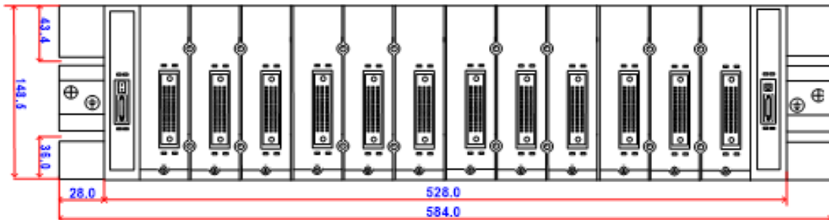
Рисунок 2.3 Монтажный размер панели с 12 слотами
